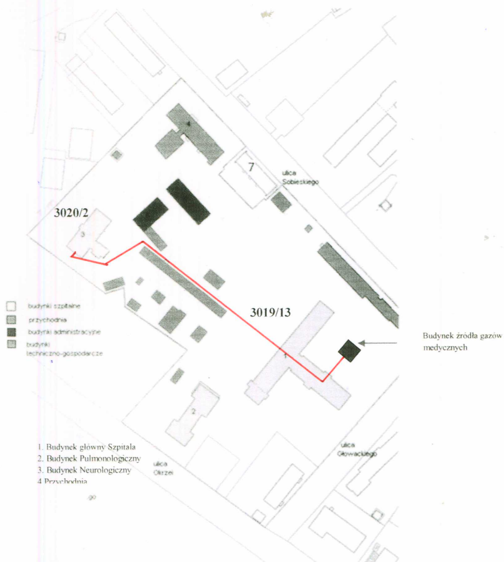
Rys. 1 Przebieg instalacji gazów tlenu medycznego do Budynku Neurologicznego.
